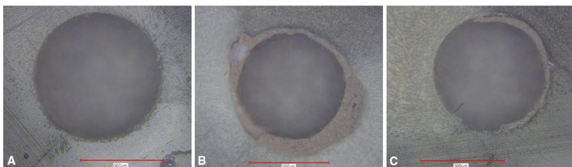
Figura 35. Imagen muestra las diferentes fallas que se pueden dar bajo microscopía láser a un aumento de 4X (A) falla Adhesiva (B) falla Cohesiva (C) falla Mixta (90)
