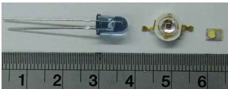
Fig. 30. Dispositivos LED utilizados en odontología y medicina, de emisión azul, roja y blanca (25).
