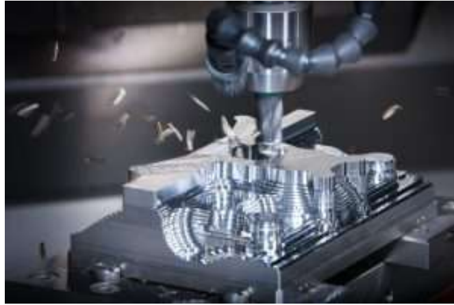
Figura 1. Fresado sustractivo de bloque de titanio. Tomado de manual Empresa Kang Ding Hardware. https://metalpartss.com/spain/De_mecanizado_CNC_prototipo_a_la_produccion_de_Entrega_Global
